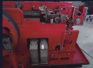
■ 雙出料口設計，避免生產時與廢料產生混料情況出現
