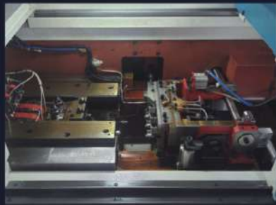
■ 整機設備操作便利性 夾仔台滑板傳動移至切刀側 a. 提升設備穩定性 b. 人員操作便利性
